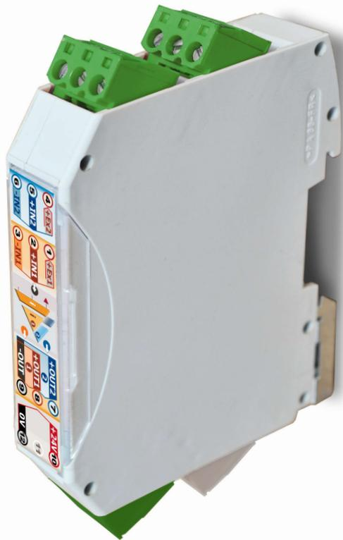
Los aisladores de 1 Y 2 canales independientes de señales 0/10V a 4/20mA (activa), separan galvánicamente circuitos de medición. Están protegidos en sus entradas y salidas contra sobrecorrientes y sobretensiones por protectores rearmables.
