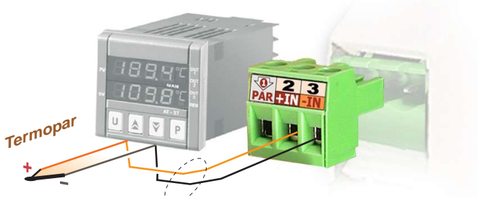
Conexión con cable normal (sin compensación)
