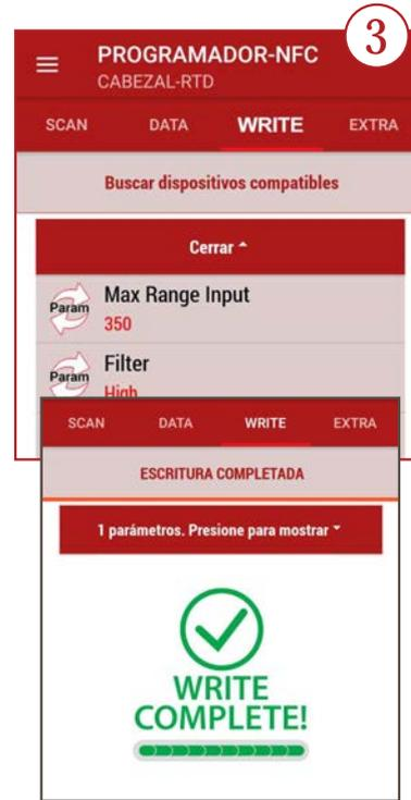
Para cargar en el equipo la nueva configuración, hay que acceder a la pestaña **WRITE** donde veremos los parámetros que hemos modificado. Aquí es donde nuevamente colocaremos el móvil en contacto con el dispositivo y esperar la notificación de que la operación ha sido completada.
