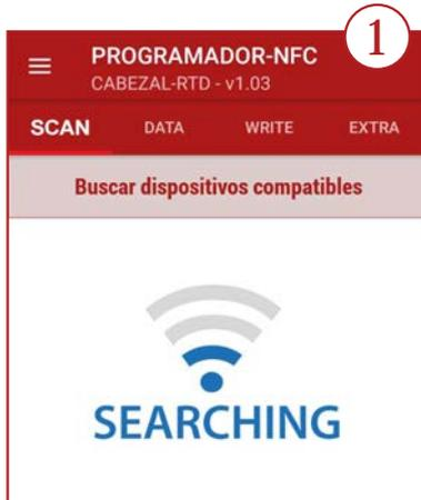
La pestaña **SCAN** permite efectuar la lectura de los datos ya grabados en el equipo. Colocando el dispositivo en contacto con el móvil, éste reconocerá automáticamente el modelo.
